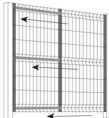
Insérez une latte d'extrémité d'un côté du panneau et une latte intermédiaire au centre. Fixez ensuite les demi-triangles de renfort (voir étape A). Répétez cette action sur l'autre moitié du panneau.
