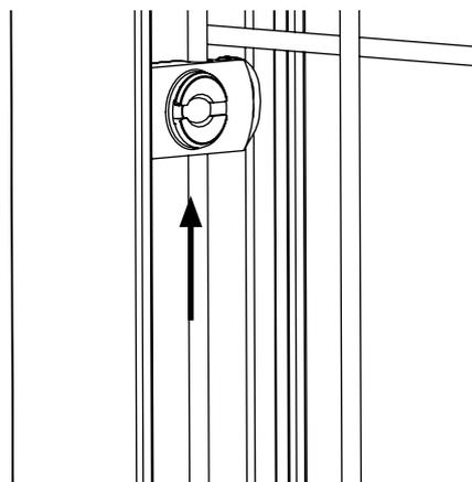
Posez un premier clip dans la battée du poteau de départ en introduisant le fil vertical dans l'un des trous.
