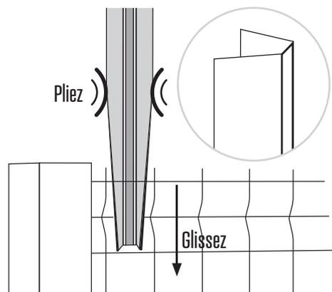
Piez les lattes en forme de triangle et glissez-les dans chaque maille de votre panneau jusqu'au profil de finition placé en bas.
