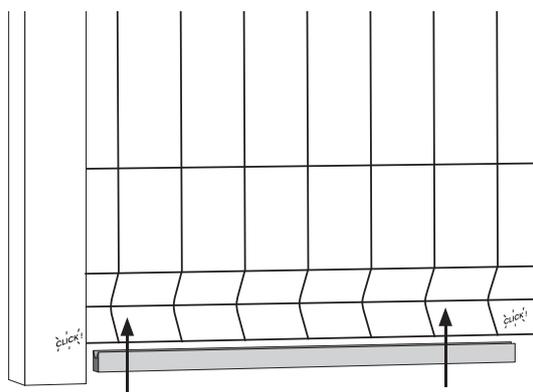
Clipsez sur le dernier fil inférieur horizontal de votre panneau les 3 profils de finition.
