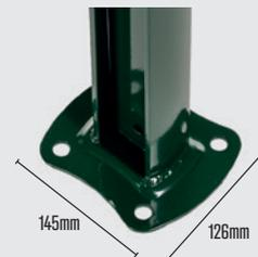
Acier galvanisé sendzimir : Zinc 140gr/m<sup>2</sup>, plastification par poudrage après phosphatation : 80 microns. Section 47x70mm. Entraxe de pose : 2m52. Capuchon avec crochet inclus. Normes EN10142, I/V : 6.55cm<sup>3</sup>, résistance à 1m du sol : 360kg.
