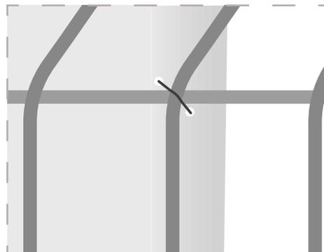
La brande se fixe sur le panneau à l'aide de fil d'attache. Ils doivent être posés, horizontalement et verticalement, tous les 25cm.
